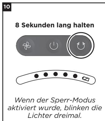
Um den Sperr-Modus zu deaktivieren und den normalen Betrieb fortzusetzen, halten Sie das **OSZILLATION**-Symbol auf der Benutzeroberfläche des Ventilator-Kopfs 8 Sekunden lang gedrückt.
