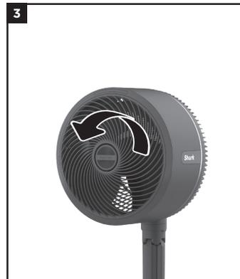
Drehen Sie das **VENTILATOR-GITTER** gegen den Uhrzeigersinn, um es vom Ventilator-Kopf zu entfernen. Legen Sie das Gitter zur Seite.
