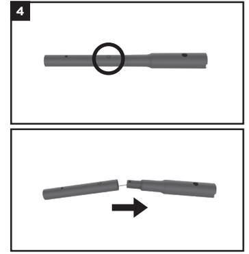
**4.** Drücken Sie die kleine Taste an der unteren Seite des Stabs, um die Stäbe voneinander zu lösen. Bei Bedarf vorsichtig zur Aufbewahrung falten. Die Kordel **NICHT** spannen.
