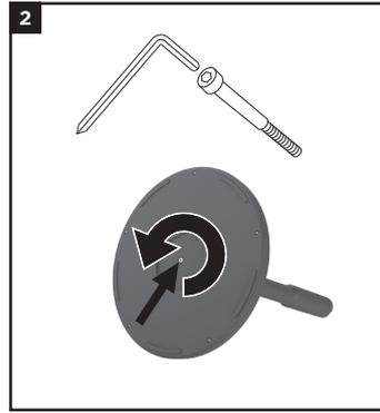
**2.** Drehen Sie die Schrauben an der Unterseite der Basis mit dem Inbusschlüssel gegen den Uhrzeigersinn. Entfernen Sie die gelöste Schraube.
