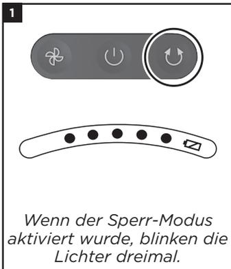
Schalten Sie den Sperr-Modus aus Sicherheitsgründen vor der Wartung ein. Halten Sie zur Aktivierung das **OSZILLATION**-Symbol auf der Benutzeroberfläche des Ventilator-Kopfs für 8 Sekunden.
