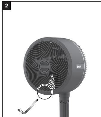
Lösen Sie die Schraube unten am **VENTILATOR-GITTER** mit dem Kreuzschlitzschraubenzieher am Inbusschlüssel.
