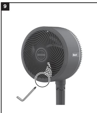
Stellen Sie den Ventilator aufrecht auf eine flache, ebene Oberfläche. Bringen Sie die Schraube mit dem Schraubenzieher am Inbusschlüssel an der Unterseite des **VENTILATOR-GITTERS** an und ziehen Sie sie fest.
