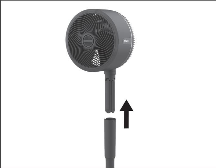
Halten Sie mit einer Hand den Griff des Ventilator-Kopfs, während Sie mit der anderen die **Lift-Away**-Taste drücken, um den Ventilator-Kopf nach oben abzunehmen.
