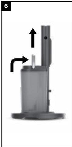
6. Heben Sie den **Wassertank** mithilfe des Griffs am Deckel vorsichtig an, um ihn von der Basis zu entfernen.
