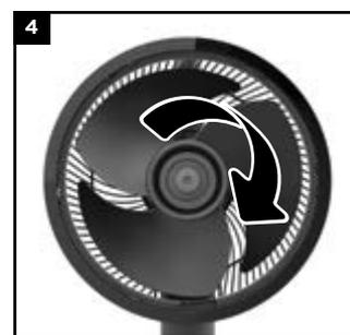
4. Entfernen Sie die Ventilatorflügelkappe. Halten Sie die Ventilatorflügel fest und drehen Sie die Ventilatorflügelkappe im Uhrzeigersinn, um sie von der Welle zu entfernen.
