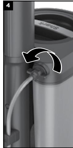
4. Um das andere Ende des Nebelschlauchs vom **Wassertank** zu lösen, drehen Sie das Anschlussstück gegen den Uhrzeigersinn.
