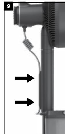
9. Den Rest des Schlauchs in den Kanal stecken und auf der Rückseite des Stabs festklemmen.
