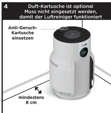
4. Stellen Sie den Luftreiniger auf einer flachen, ebenen Fläche mit einer Entfernung von mindestens 8 cm von Wänden und Gegenständen auf.
