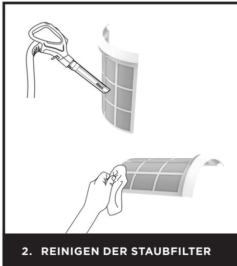
**2. REINIGEN DER STAUFILTER**
