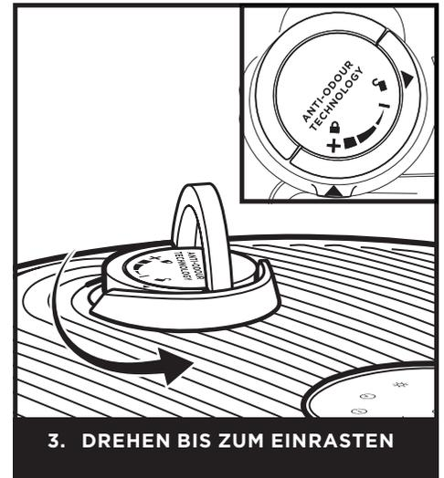
Zum Verriegeln und Aktivieren der Duftkartusche drehen Sie diese gegen den Uhrzeigersinn, bis es mindestens einmal klickt. Drehen Sie den Drehknopf weiter in die Position „Hoch“, um die Intensität zu erhöhen.
