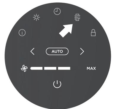
**Hinweis:** Die HEPA-Filter-Technologie ermöglicht es, einen HEPA-Filter bis zu fünf Jahre\* lang zu nutzen. \*Getestet gemäß GB/T18801-2015 P.CCM, basierend auf 50 % zurückgegangener CADR, 12 m<sup>2</sup> Reinigungsbereich und 12 Stunden täglichem Einsatz mit maximaler Ventilatorgeschwindigkeit.
