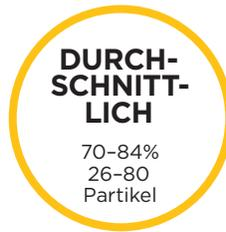
Ein gelber Ring bedeutet, dass der Luftreinigungsstatus durchschnittlich ist und eine mäßige Partikelkonzentration aufweist. Um bessere Ergebnisse zu erzielen, kann die Ventilatorgeschwindigkeit erhöht oder der Auto-Modus ausgewählt werden.
