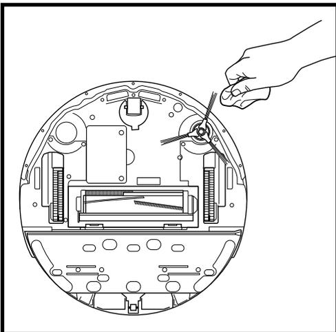
1. Entfernen Sie die Seitenbürste vom Saugroboter.
