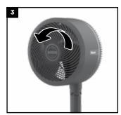
**3.** Drehen Sie das **Ventilatorgitter** gegen den Uhrzeigersinn, um es vom Ventilatorkopf abzunehmen. Legen die das Gitter zur Seite.
