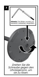
7. Drehen Sie den Standfuß auf die Seite, um an die Inbusschraube an der Unterseite zu gelangen. Verwenden Sie den mitgelieferten Inbusschlüssel, um die Schraube gegen den Uhrzeigersinn zu drehen, und entfernen Sie dann die Schraube.
