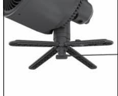
TISCHMODUS: Um den Ventilator im Tischmodus aufzuladen, stecken Sie das Ladegerät in den Ladeanschluss unter dem mittleren Schaft des Ventilators zwischen die vier Stützbeine. NICHT IM REGEN AUFLADEN ODER VERWENDEN.
