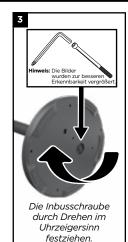
3. Die Basis auf die Seite drehen und die Inbusschraube in die Unterseite der Basis einführen. Die Inbusschraube mit dem Inbusschlüssel im Uhrzeigersinn drehen, um sie am montierten Stab zu befestigen.
