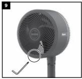
9. Stellen Sie den Ventilator aufrecht auf eine flache, ebene Fläche. Verwenden Sie die Kreuzschlitz-Seite des Inbusschlüssels, um die Schraube an der Unterseite des Ventilatorgitters zu ersetzen und festzuziehen.
