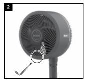
Stellen Sie den Ventilator aufrecht auf eine flache, ebene Oberfläche im Tisch-Modus. Verwenden Sie die Kreuzschlitz-Seite des Inbusschlüssels, um die Schraube an der Unterseite des Ventilatorgitters zu entfernen. Legen Sie sie zur Seite.
