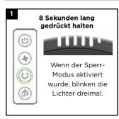
Schalten Sie den Sperr-Modus aus Sicherheitsgründen vor der Wartung ein. Zum Aktivieren halten Sie das Oszillations-Symbol am Ventilatorkopf für 8 Sekunden gedrückt.
