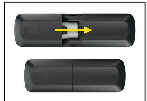
**1.** Um die Batterien zu entnehmen, drücken Sie leicht auf das Batteriefach auf der Rückseite der Fernbedienung und schieben Sie es dann ab. Nehmen Sie die Batterien aus der Kammer und befolgen Sie die örtlichen Vorschriften für die Batterieentsorgung.
