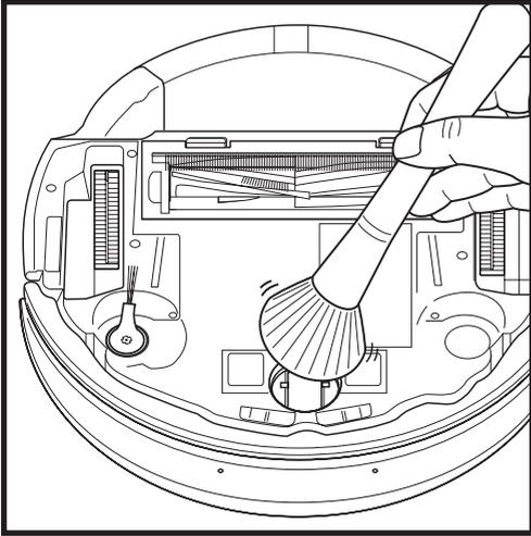
Reinigen Sie das Radgehäuse.
