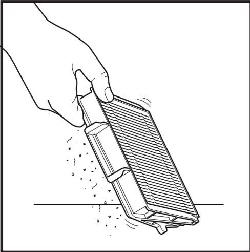
Klopfen Sie den Filter jedes Mal leicht aus, wenn Sie den Staubbehälter leeren, um Schmutz zu entfernen. Für eine gründlichere Reinigung spülen Sie den Filter einmal im Monat mit Wasser aus. Lassen Sie den Filter mindestens 24 Stunden lang an der Luft trocknen, bevor Sie ihn wieder einsetzen. Verwenden Sie keine Seife und schrubben Sie den Filter nicht. Dadurch wird das Material beschädigt.
