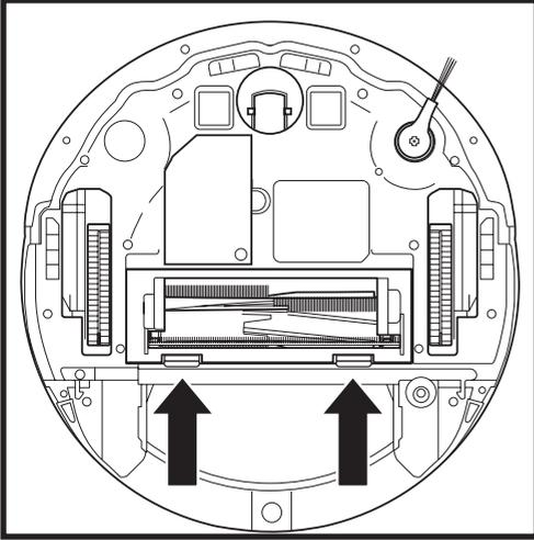
Um an die Bürstenrolle zu gelangen, drücken Sie die Laschen an der Bürstenrollenabdeckung nach oben und heben Sie die Abdeckung ab.
