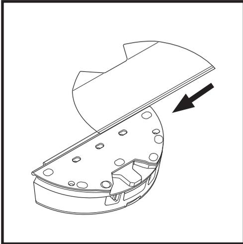
Befestigen Sie das Wischpad, indem Sie die flache Kante des Pads durch den Schlitz im Vac & Mop 2-in-1-Staubbehälter führen. Ziehen Sie das Wischpad ganz durch den Schlitz, bis es sicher eingesetzt ist.
