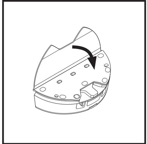
Befestigen Sie das Pad am Vac & Mop 2-in-1-Staubbehälter.
