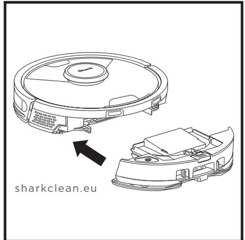
Schieben Sie den Vac & Mop 2-in-1-Staubbehälter fest in die Rückseite des Roboters und stellen Sie sicher, dass beide Verriegelungen einrasten. Die Taste >|| auf dem Saugroboter leuchtet blau auf, wenn der Vac & Mop 2-in-1-Staubbehälter korrekt eingesetzt ist.
