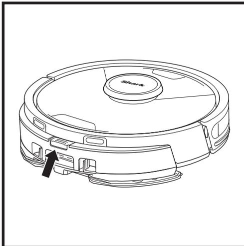
Wenn das Wischen beendet ist, entnehmen Sie den Vac & Mop 2-in-1-Staubbehälter, indem Sie die Füllöffnungstaste drücken und ihn herauschieben. Leeren Sie den Behälter nach jeder Verwendung. Der Staubbehälter entleert sich automatisch in die selbstentleerende Basis, wenn der Saugroboter andockt.
