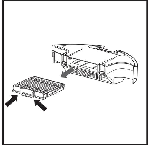
Ziehen Sie den Filter an den Laschen aus dem Staubbehälter heraus.
