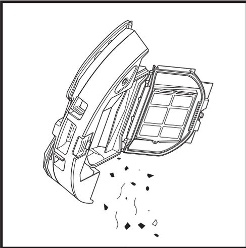
Nehmen Sie den Filter heraus und wischen Sie den Staubbehälter mit einem feuchten Tuch sauber. Lassen Sie den Behälter 24 Stunden lang an der Luft trocknen, bevor Sie ihn wieder einsetzen.
