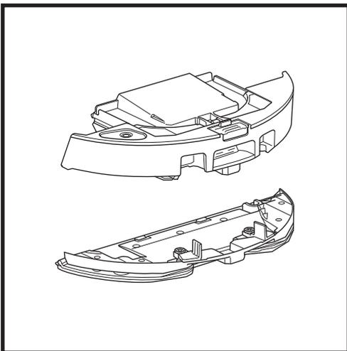
Um mit der reinen Staubsaugerreinigung zu starten, entfernen Sie die Wischplatte aus dem Staubbehälter des Saugroboters.
