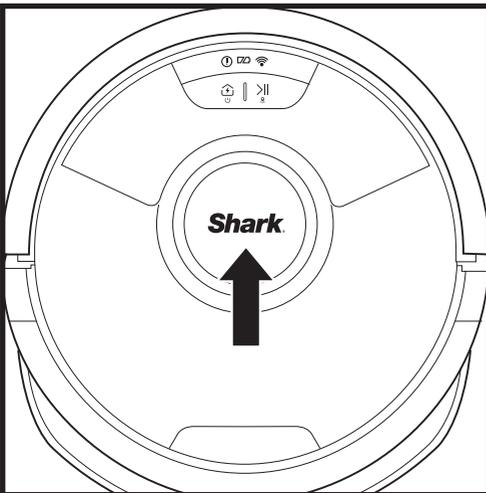
Überprüfen Sie das LIDAR-Navigationsmodul auf dem Saugroboter regelmäßig auf Haare und Schmutz. Entfernen Sie Haare und Schmutz vorsichtig vom Modul.
