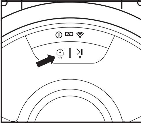
Zum **EINSCHALTEN DES SAUGROBOTERS**: Bringen Sie den Saugroboter zum DOCK (LADESTATION) und halten Sie die DOCK (LADESTATION)-Taste 5 bis 7 Sekunden lang gedrückt, bis die Anzeigelampen angehen.
