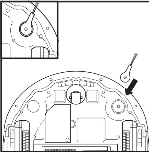
Rasten Sie die mitgelieferte **Seitenbürste** in die viereckigen Zapfen an der Unterseite des Saugroboters ein.
