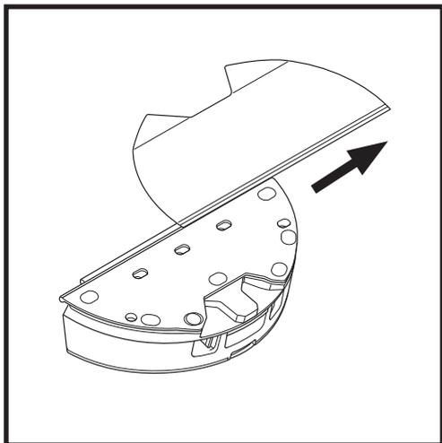
Um das Wischpad vom Vac & Mop 2-in-1-Staubbehälter abzunehmen, lösen Sie das Pad von der Rückseite der Wischplatte ab und schieben Sie es aus dem Schlitz heraus.
