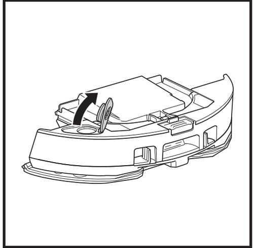
Um den Deckel des Staubbehälters zu öffnen, drücken Sie die seitlichen Verriegelungen in die Fingermulden und halten sie fest, während Sie den Deckel anheben.
