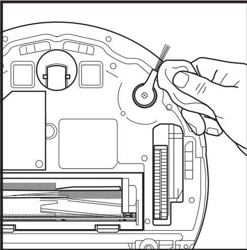
Lösen und entfernen Sie vorsichtig alle Fäden oder Haare, die sich möglicherweise um die Bürste gewickelt haben.
