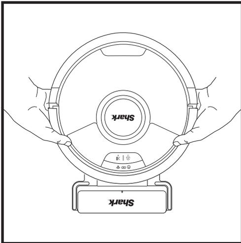
Wenn der Reinigungszyklus abgeschlossen ist oder der Akku schwach wird, sucht der Saugroboter nach der Ladestation. Wenn der Saugroboter nicht zur Ladestation zurückkehrt, ist möglicherweise die Ladung aufgebraucht. Wenn er sich im Nassreinigungsmodus befindet, kann es sein, dass die Ladestation durch Teppiche blockiert wird.
