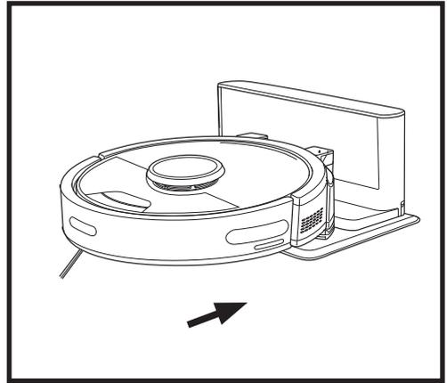
Wenn der Akku des Saugroboters leer ist und er nicht zur Ladestation fahren kann, tragen Sie ihn dorthin. Ist er korrekt auf der Ladestation aufgestellt, leuchtet die Anzeigelampe blau und der Saugroboter gibt einen Signalton ab.
