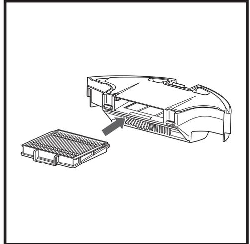
Setzen Sie den Filter wieder in den Staubbehälter ein und schieben Sie den Staubbehälter in den Saugroboter, bis er einrastet.
