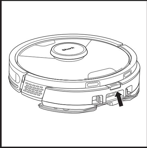
Um den Vac & Mop 2-in-1-Staubbehälter zu entnehmen, drücken Sie die Entriegelungstaste oben am Staubbehälter und schieben Sie ihn heraus.
