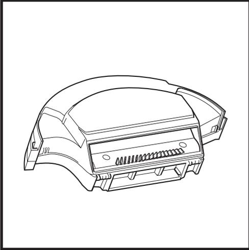
Entfernen und leeren Sie den Staubbehälter. Entfernen Sie Haare oder Schmutzablagerungen aus dem **Anti-Verwicklungskamm** auf der Rückseite des Staubbehälters.
