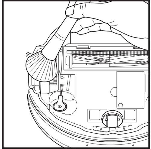
Reinigen Sie regelmäßig die Antriebsräder und das sie umgebende Gehäuse. Drehen Sie zum Staubwischen jedes Antriebsrad herum.
